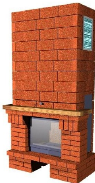
Ukázka obezdění vložky s umístěním PTZ
